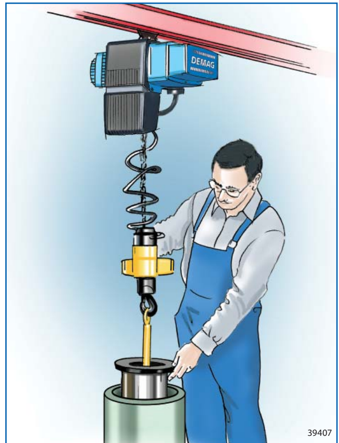
Мягкое и точное позиционирование катушки в разматывающем устройстве
